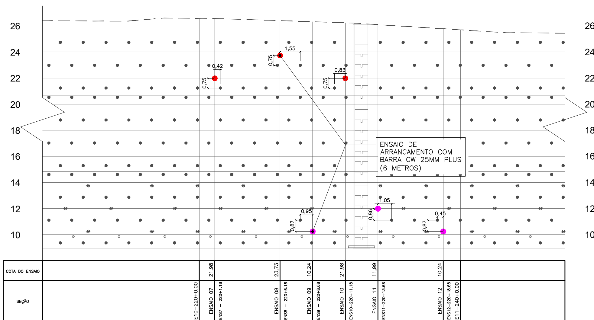
ENSAIO DE ARRANCAMENTO NA REGIÃO REPRESENTATIVA 03 E 04 ESCALA: 1/175
